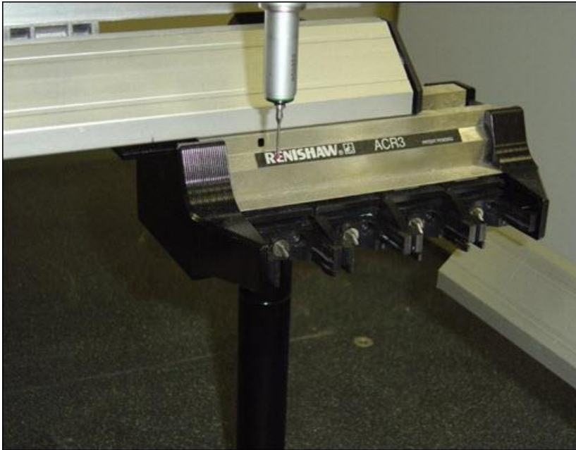
Esempio del sistema di cambio dei tastatori ACR3 sul lato destro della corsa di escursione.
