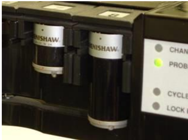
Sistema di cambio dei tastatori ACR1 che mostra due diverse prolunghe nelle porte 7 e 8.
