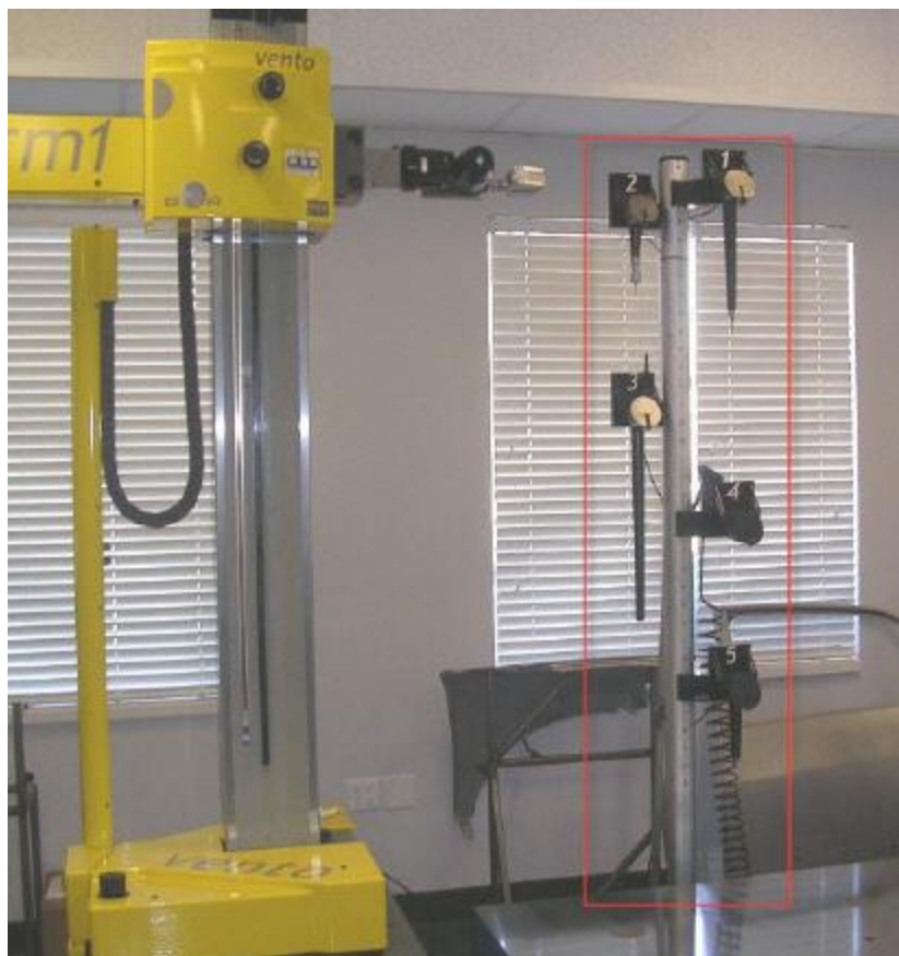
Sistema di cambio dei tastatori verticale CW43 con cinque porte
