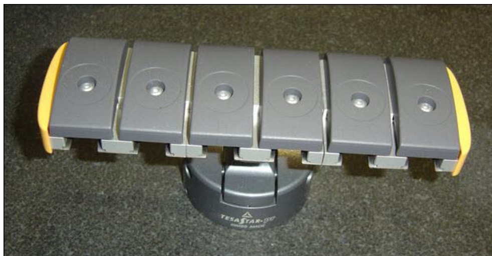
Magazzino del sistema di cambio dei tastatori TESASTAR-PR/HR-P
