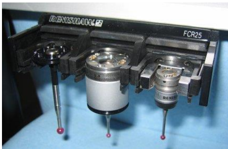
Tipi di inserti e di tastatori nel sistema di cambio dei tastatori FCR25
