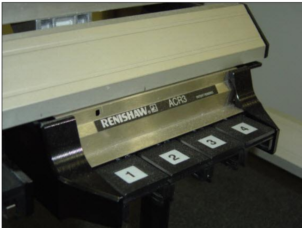
Magazzino del sistema di cambio dei tastatori Renishaw ACR3
