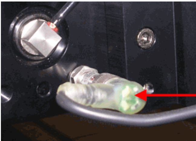
Connessione solenoide con LED verde e ambra
