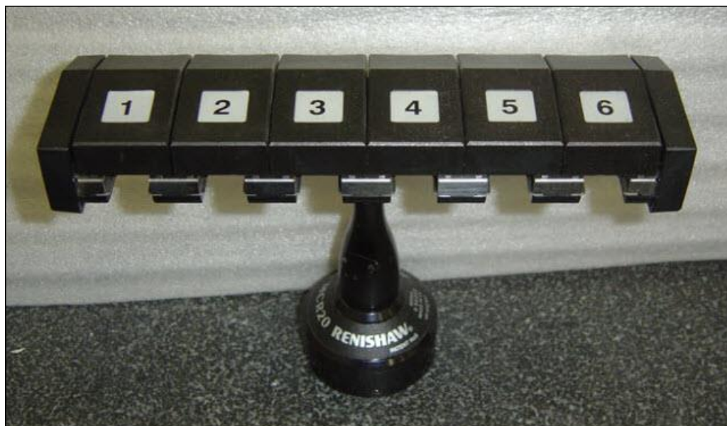
Magazzino del sistema di cambio dei tastatori TP20
