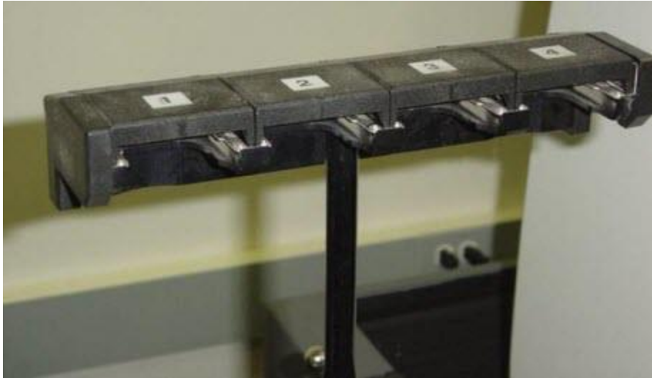
Magazzino di un sistema di cambio stilo Renishaw SP600 (SCR600)
