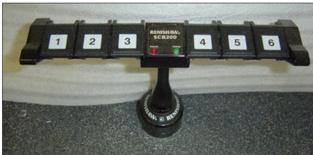
Magazzino del sistema di cambio dei tastatori TP200
