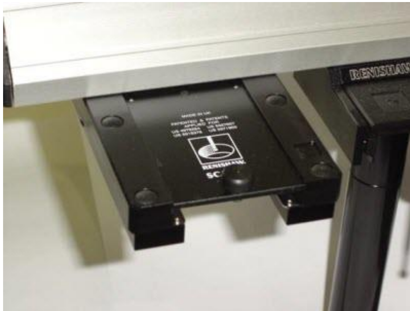
Magazzino di un sistema di cambio stilo Renishaw SCP600
